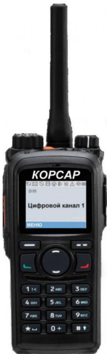
Радиостанция КОРСАР КР-824 разработана в соответствии со стандартом DMR и протоколами STD900 и STD290.
